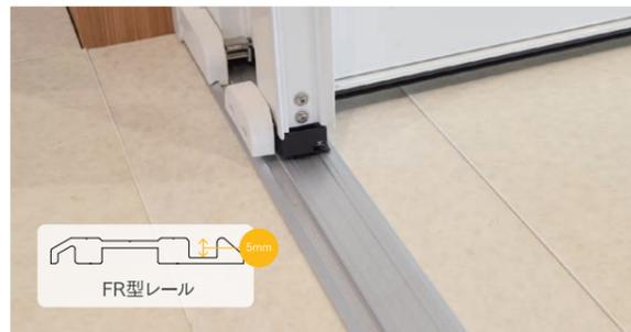
ハツリ工事不要で床仕上げ後でも取り付け可能。溝の深さは5mmで、ビス止め可能な置き型底段差レールです。
