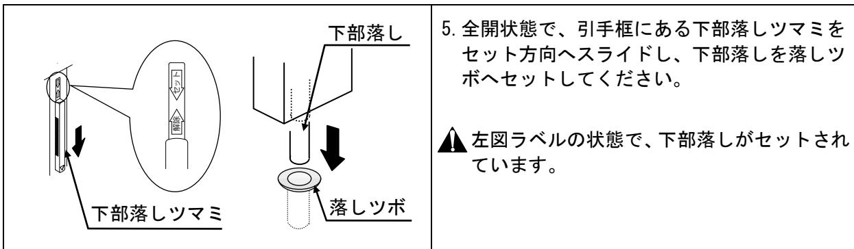
5. 全開状態で、引手框にある下部落しツマミをセット方向へスライドし、下部落しを落しツボへセットしてください。
