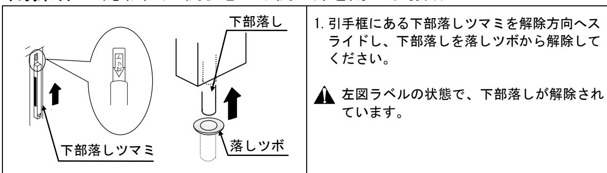
1. 引手框にある下部落しツマミを解除方向へスライドし、下部落しを落しツボから解除してください。
