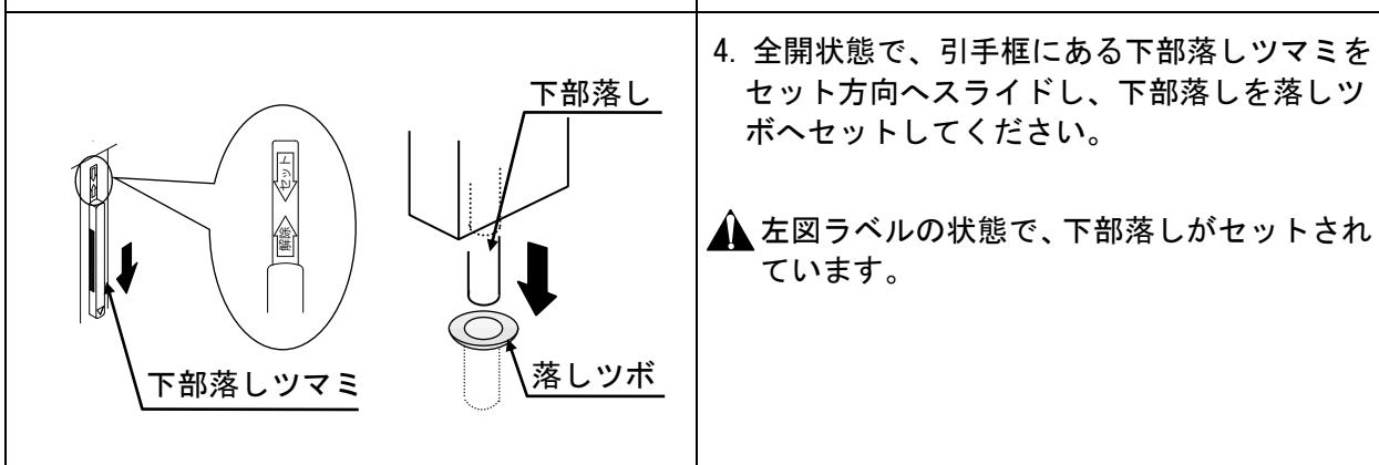
4. 全開状態で、引手框にある下部落しツマミをセット方向へスライドし、下部落しを落しツボへセットしてください。
